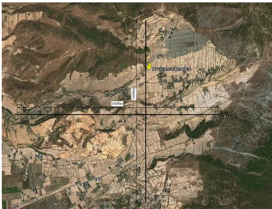
图 1 冕宁县漫水湾镇电阻率测深测线示意图
